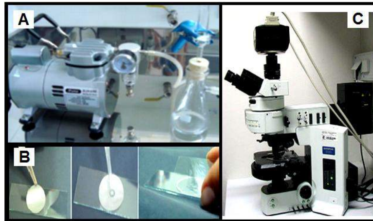
Figura 13. Preparação das lâminas para microscopia de epifluorescência. (A) Sistema de filtração, contendo suporte de vidro acoplado em uma bomba a vácuo; (B) Montagem das lâminas; (C) Microscópio invertido de fluorescência Axiops 50, Zeiss.
